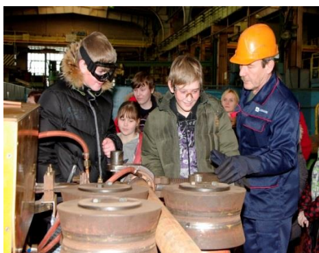
Гибка труб традиционными методами.
